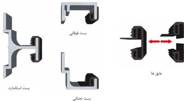
شکل ۷-۵- نصب درزپوش بر روی مهارها
