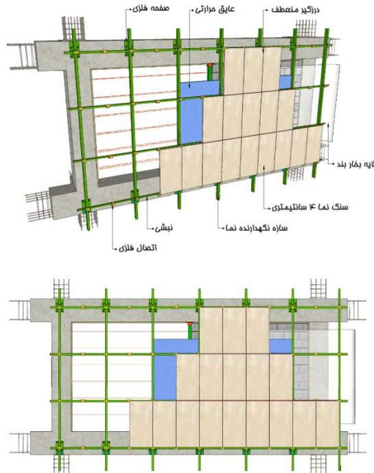
شکل ۴-۱۳- جزئیات اجرای نمای پرده‌ای سنگی
