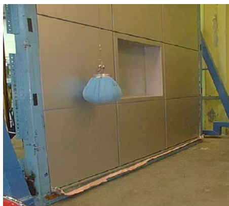
شکل ۳-۵- آزمایش ضربه جسم نرم سنگین روی نما
