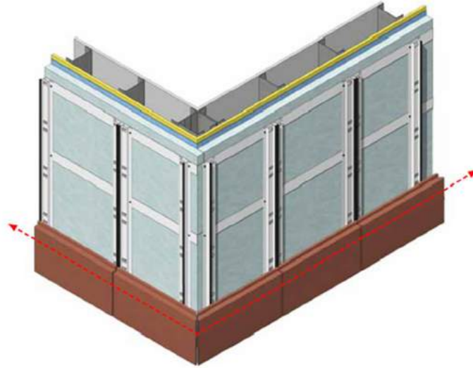
شکل ۷-۱۵- کنترل تراز بودن پنل‌ها
