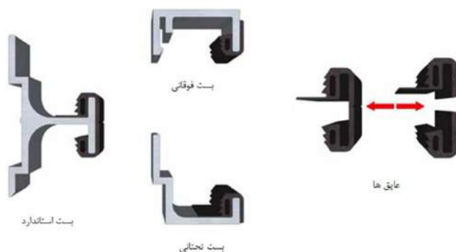
شکل ۷-۱۱ - نصب درزپوش بر روی بست‌ها
