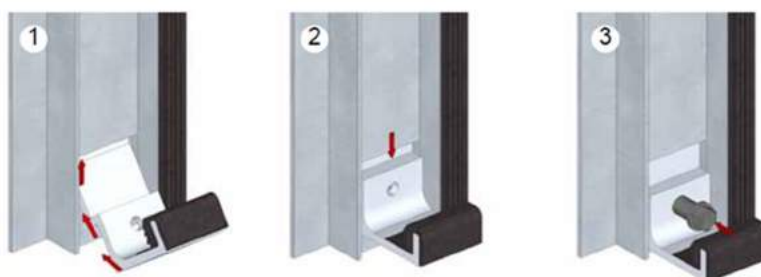
شکل ۷-۱۲ - نحوه نصب بست‌ها بر روی ریل
