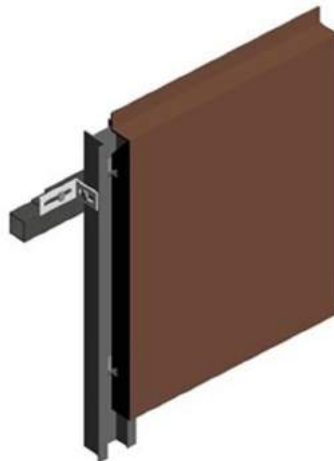
شکل ۸-۴- نمونه ای از روش اجرای هوک
