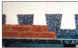
الف- وسیله مهار ملات که در فضای خالی نصب شده است.
