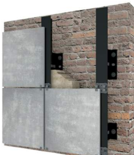
شکل ۷-۲۲- اجزای سیستم نصب نمایان
